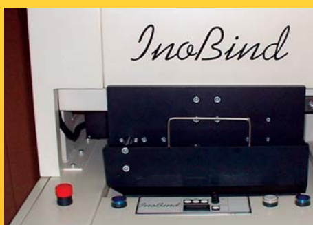
Poste de chargement
